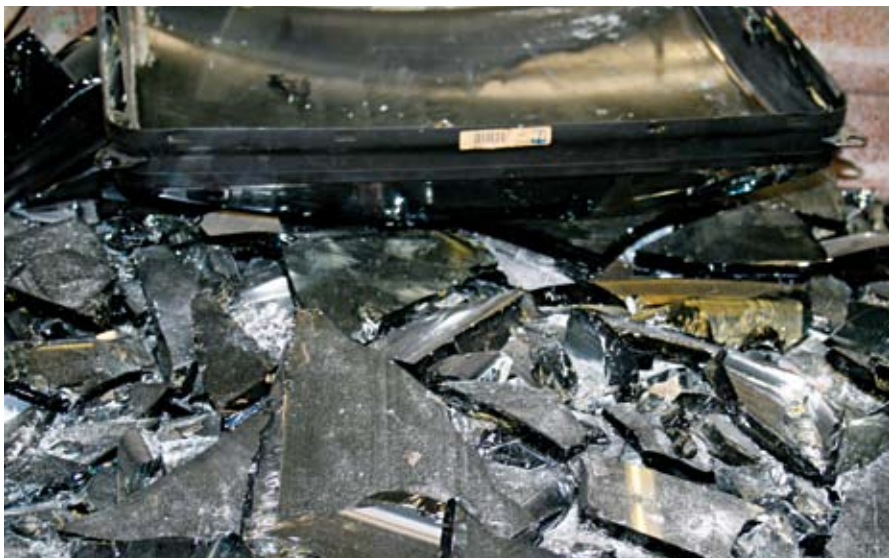
Abb. 4: Werkstoffliches Recycling von Bildröhren unter Laserschnitt-Trennung (oben) der bleihaltigen Rückseite (Pb, Mitte) von jener der barium- und strontiumhaltigen Vorderseite (Ba/Sr, unten).
