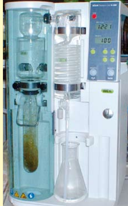
Abb. 3: Destillation der mit wasserdampflichten Fettsäuren aus einer Fermenterprobe.
